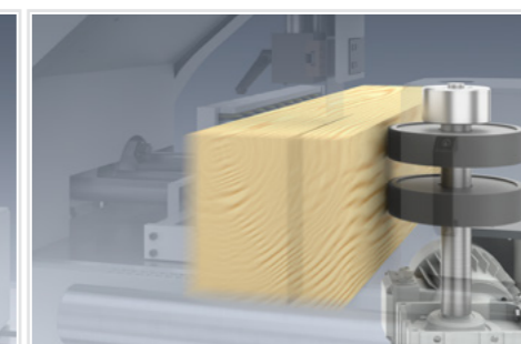
Posuw regulowany bezstopniowo częstotliwościowo w zakresie 5-40 m/min
